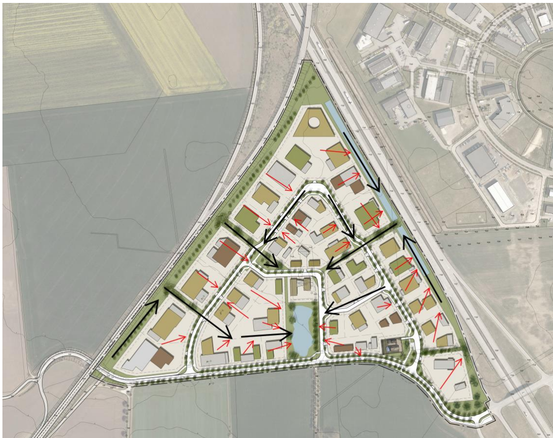
Figur 7: Lutningsförslag efter exploatering, röda pilar är föreslagen lutning på fastigheter. Svartapilar visar tänkta flöden vid regn som överskrider dimensionerande regn.
