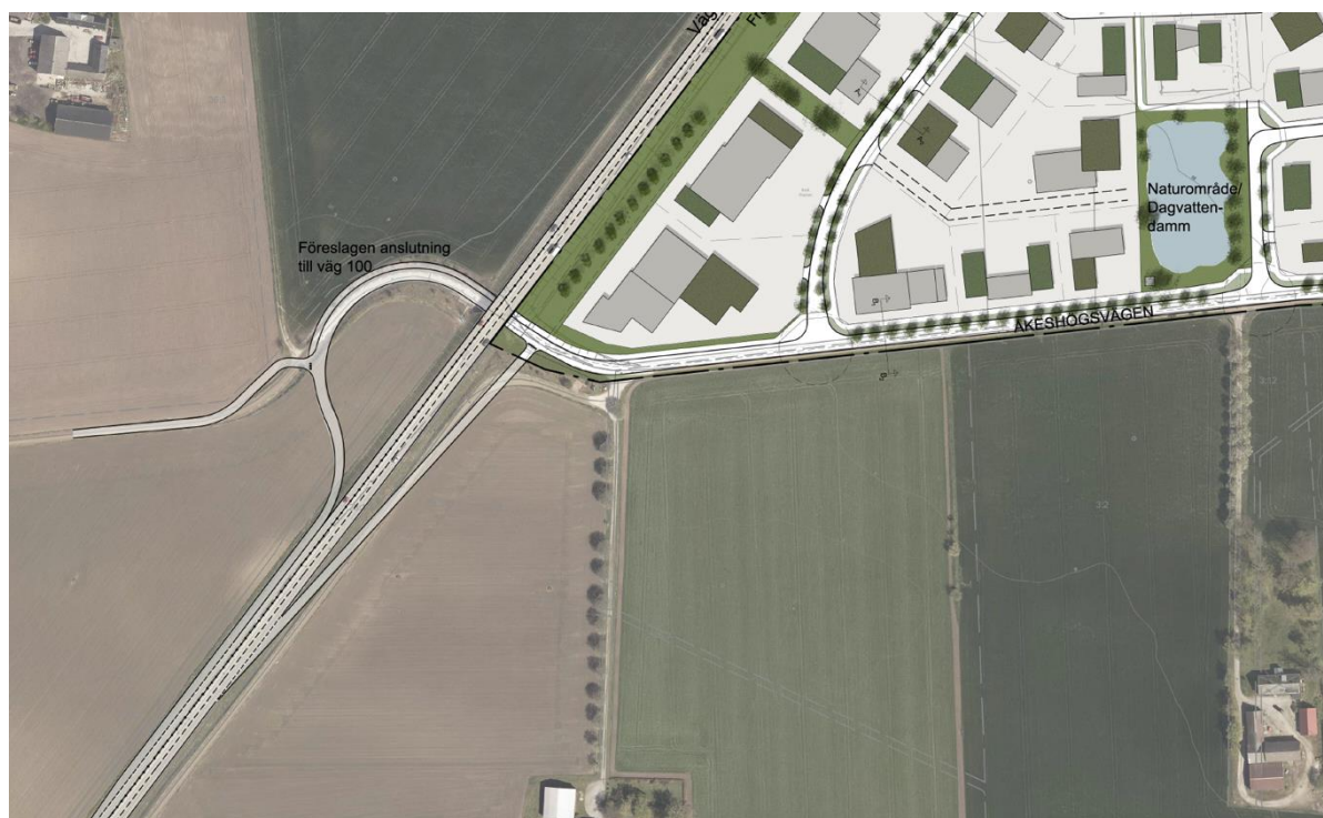
Principlösning för ny anslutning till väg 100 (utsnitt från illustrationsplanen).
