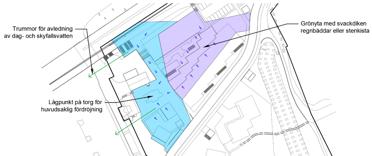
Figur 36 Avrinningsområden, huvudsakliga områden för infiltrationsanläggningar samt trummor för avledning av dag- och skyfallsvatten (ENVIDAN, 2020-04-20)
