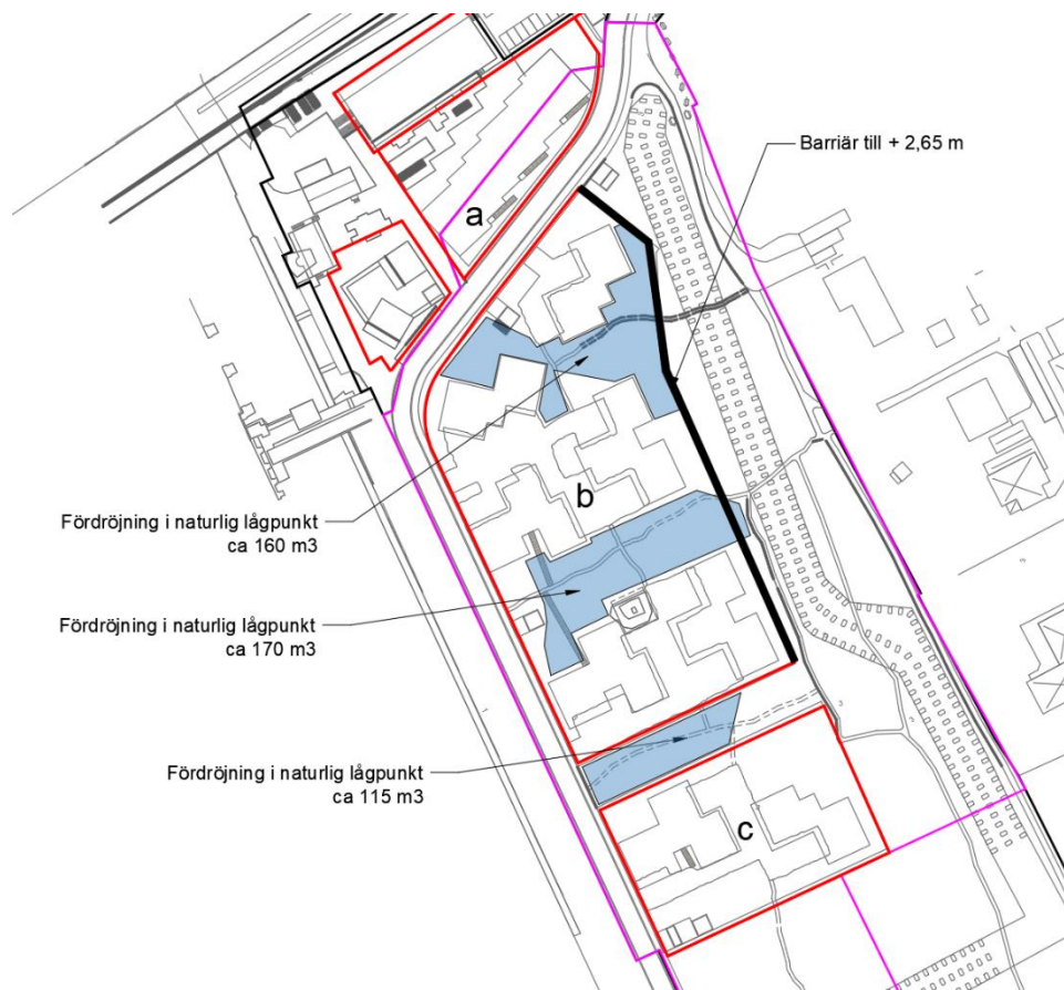
Figur 2 Primär fördröjningsytor för 20-årsregn i naturliga lågpunkter runt byggnader och körbara ytor
