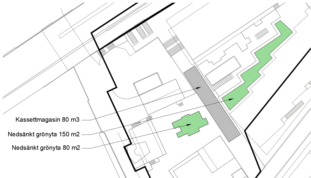
Figur 38 Förslag på placering av anläggningar om trummor till kanalen inte finns tillgängliga och området ska ta hand om ett 20-årsregn
