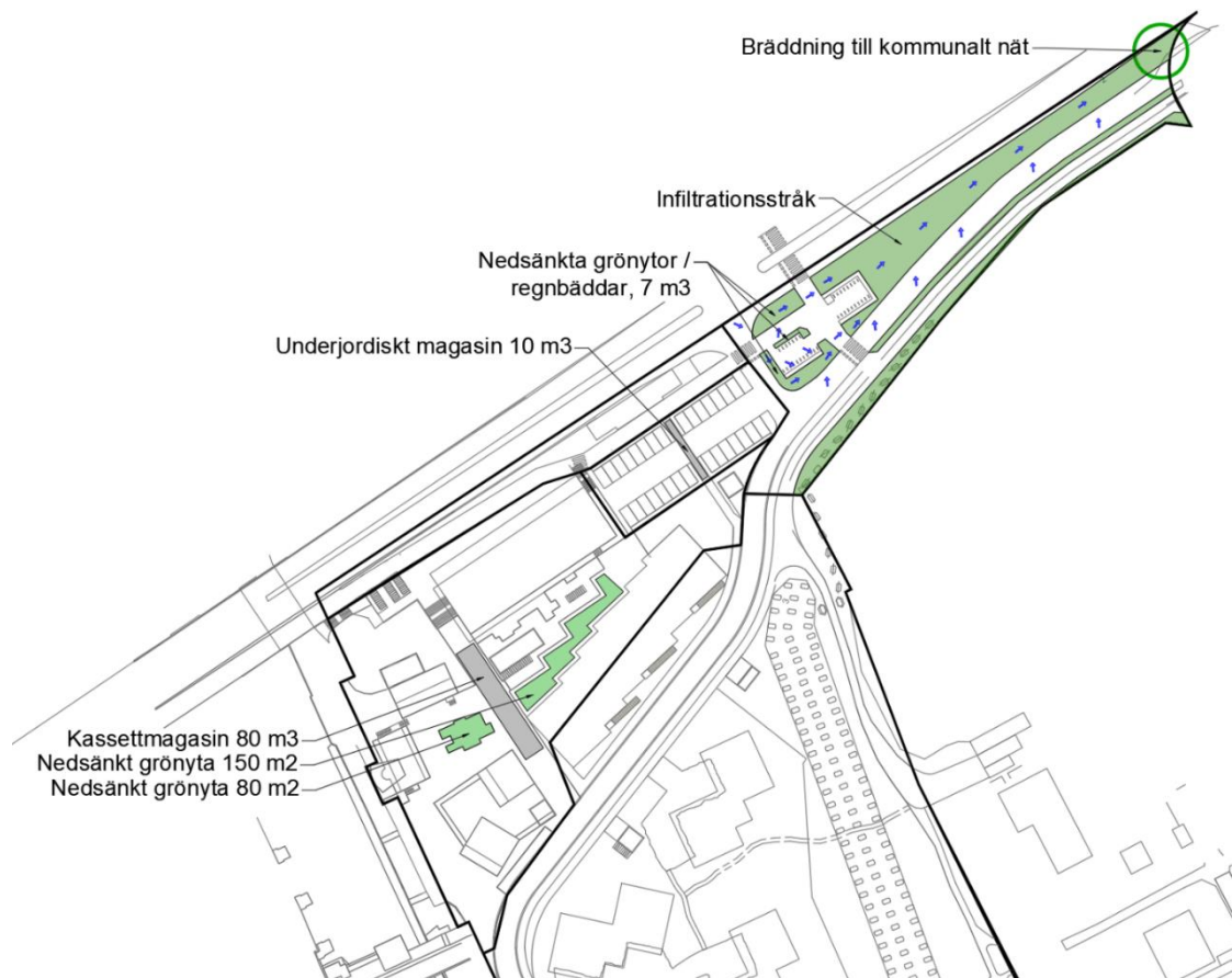
Figur 3 Översiktsskild över föreslagna dagvattenåtgärder i område 2 - 5
