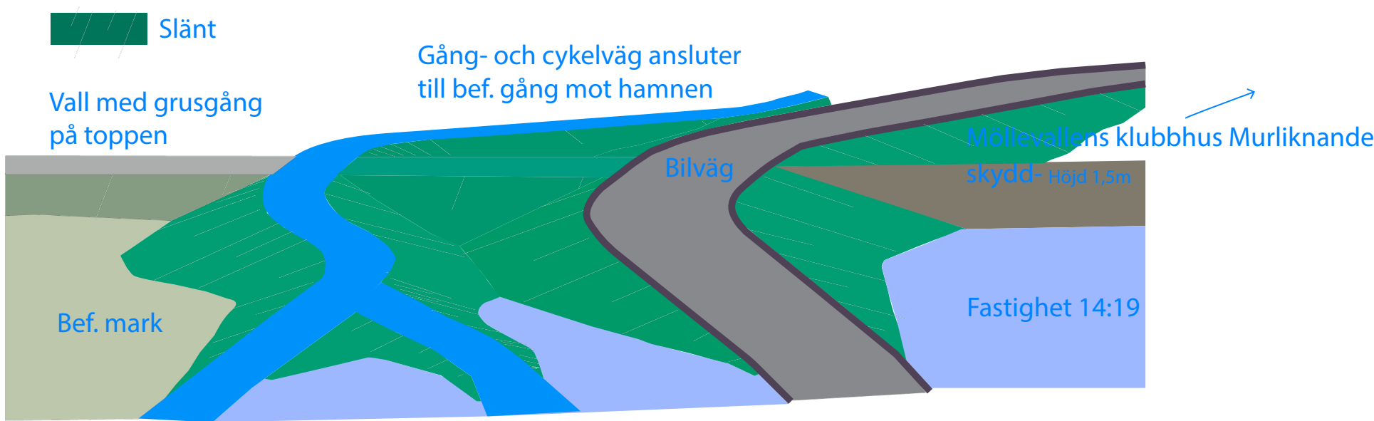
Principskiss passage över vall, från Axelssons torg till MöllevalLEN
