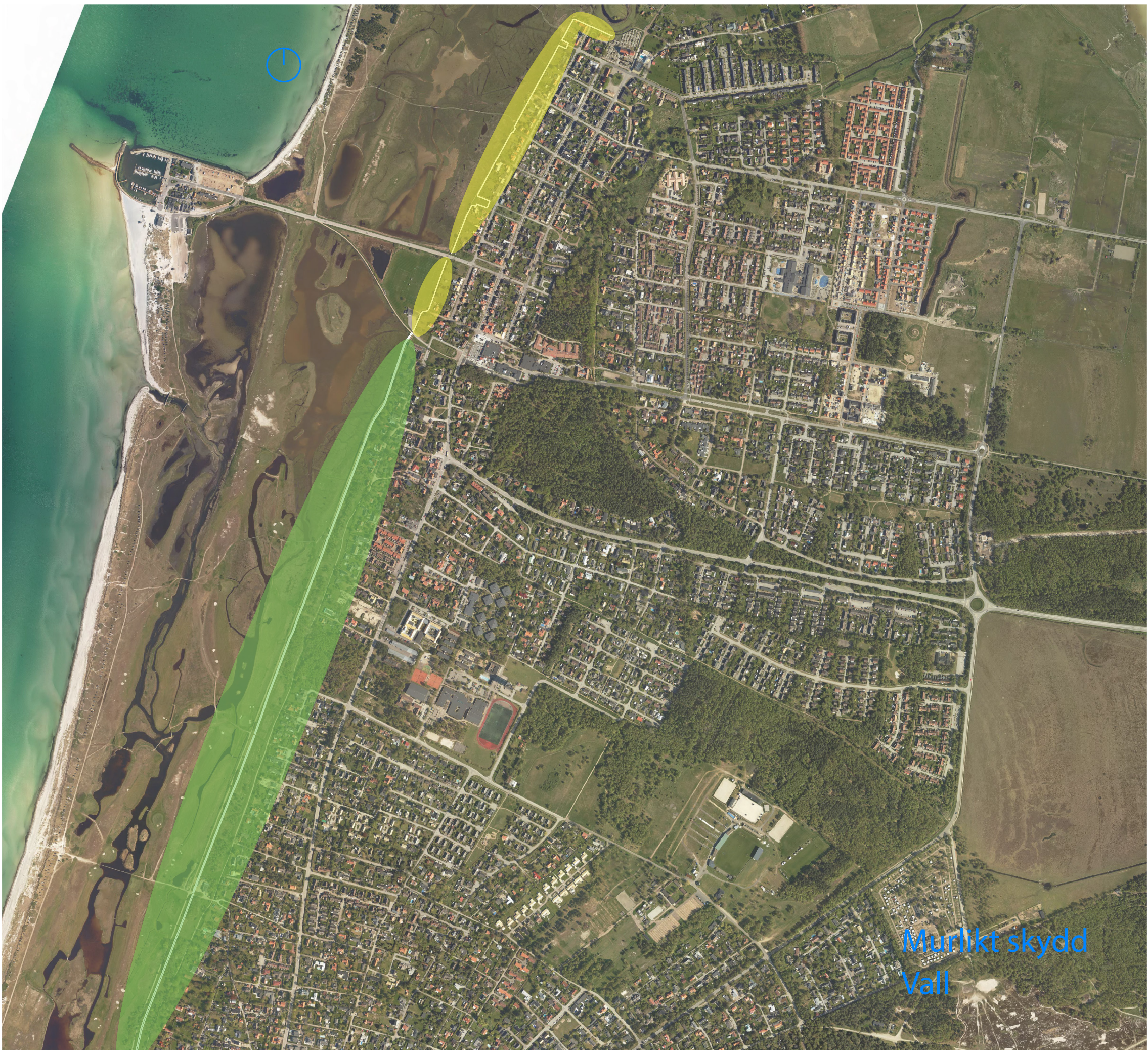
Murlikt skydd mellan privata fastigheter i Norra Skanör och Flommens naturreservat samt vid Möllevallen. Skyddsvallen följer befintlig banvall.
